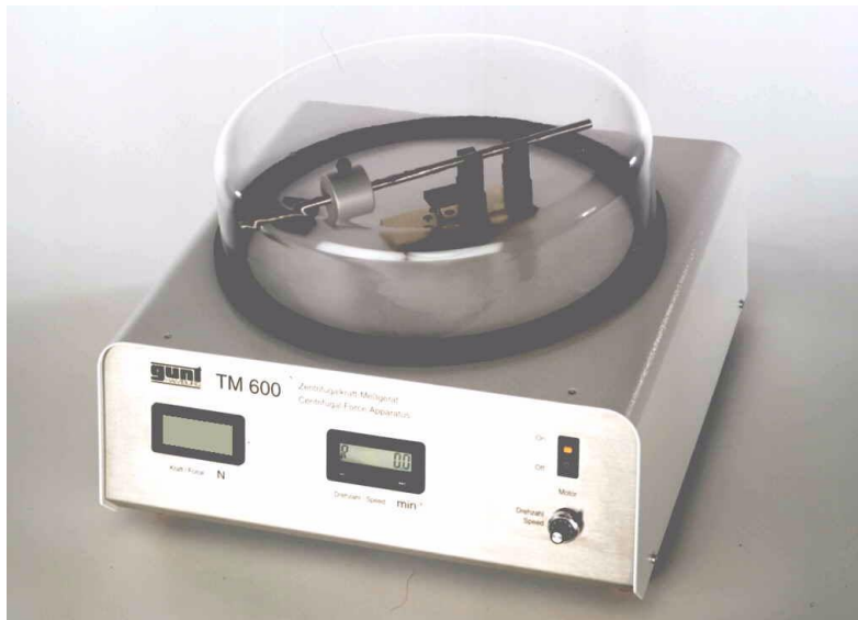
Rys. 8.4. Stanowisko pomiarowe firmy GUNT TM 600 [3] do badania siły odśrodkowej bezwładności
